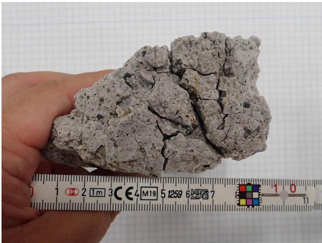
図 4 一番大きな白色軽石の表面構造 パン皮状クラックが認められる。
