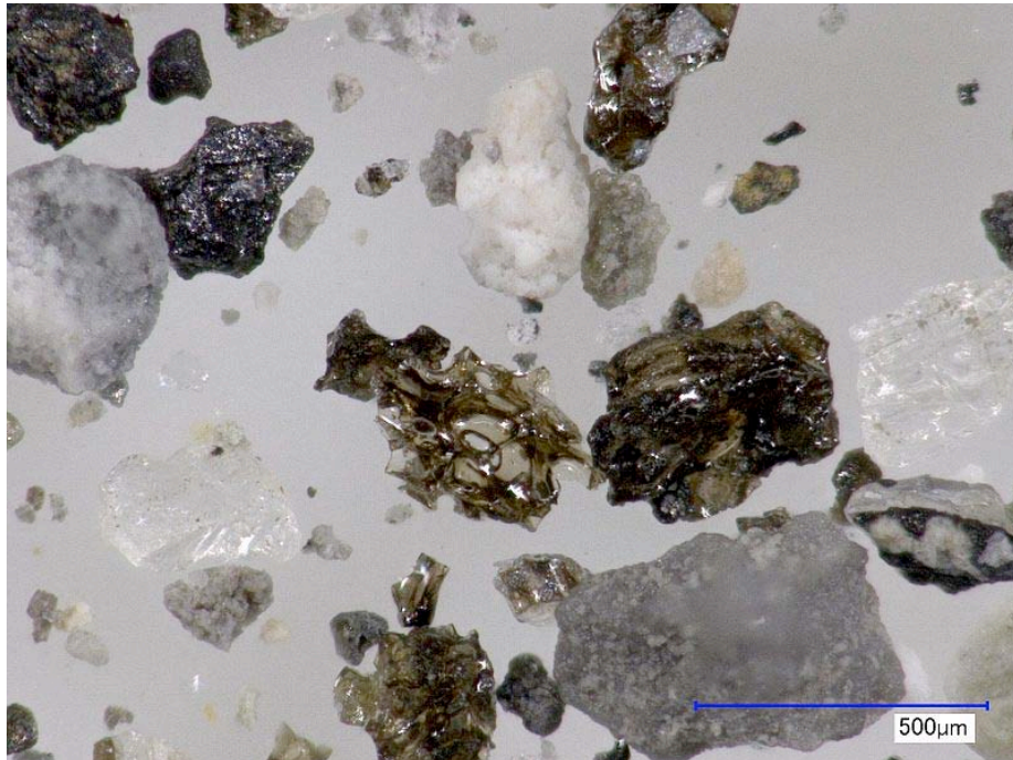
写真2 10月24日採取火山灰に含まれる、よく発泡した褐色火山ガラス質粒子。
