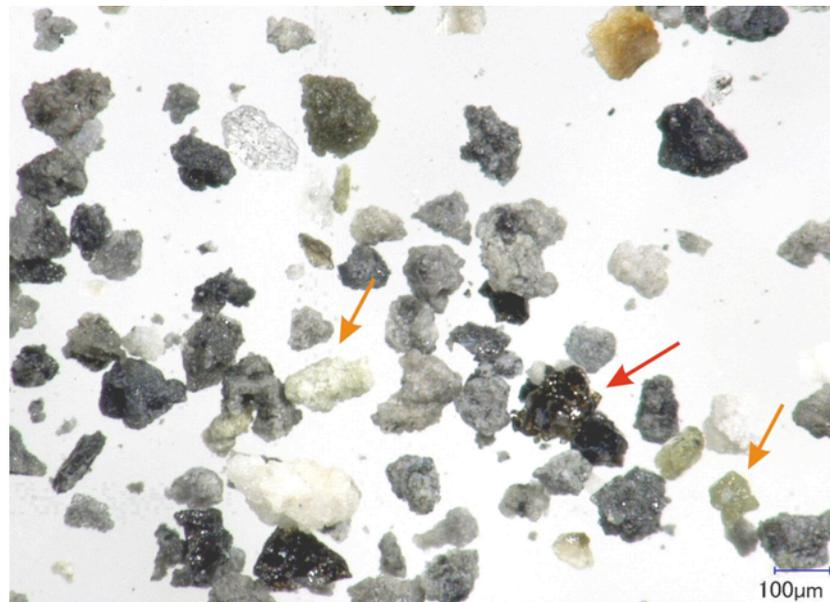
図1 8月30日火山灰の光学顕微鏡写真。赤矢印はマグマ物質と考えられる発泡した褐色ガラス質粒子，橙矢印は自然硫黄と思われる黄色粒子。
