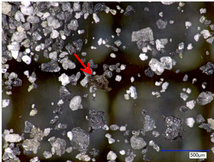
写真1 11月25日14:20採取の火山灰の光学顕微鏡写真。発泡した茶褐色ガラス片を赤矢印で示す。スケールバー0.5mm.
