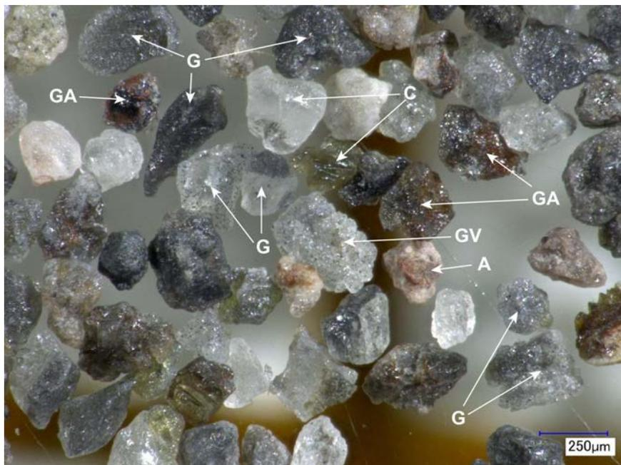
図1. 浅間火山6月16日噴火の構成粒子。GV: GV粒子, G: G粒子, GA: GA粒子, A: A粒子, C: C粒子。
