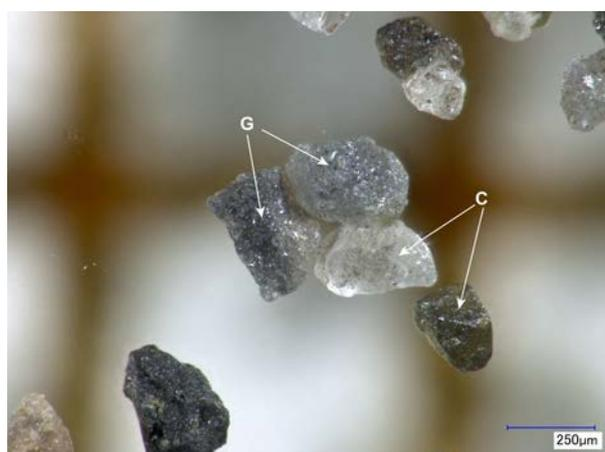
図 5. 結晶質で緻密なガラス質火山灰粒子(G 粒子)と結晶粒子(C 粒子). G 粒子は破断面で囲まれていることがある.
