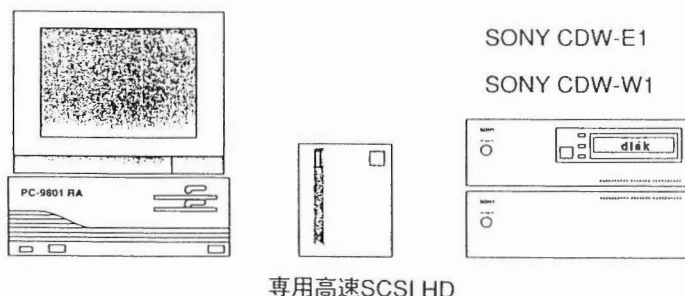
第7図 CD-ROM 作成システムのハードウェア構成 Fig. 7 Hardware components of CD-ROM writing system.
