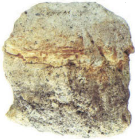
リンカイウラン石 Autunite \text{Ca}(\text{UO}_2)_2(\text{PO}_4)_2 \cdot 10\text{H}_2\text{O} 産地：鳥取県東郷鉱山（麻畑） スケール：横12cm×高さ13cm 説明：黄色部分 ほかは砂岩 平均品位 8.89% \text{U}_3\text{O}_8 黄色高品位部 23.4% \text{U}_3\text{O}_8 （動力炉・核燃料開発事業団提供）
