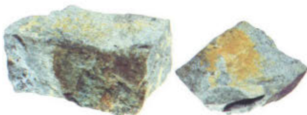
ベータウラノフェン \beta -Uranophane \text{CaO} \cdot 2\text{UO}_3 \cdot 2\text{SiO}_2 \cdot 6\text{H}_2\text{O}
