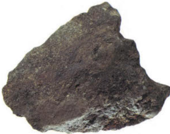
センウラン鉱 Uraninite \text{UO}_2 \cdot \text{UO}_3 産地：岐阜県土岐市 スケール：横19cm×高さ15cm 説明：黒色斑点状の部分 母岩は砂質凝灰岩 右下灰白色部は比較的具化石の多い部分で保存のよい 2枚貝も含まれている 平均品位 2% \text{U}_3\text{O}_8 高品位部分 50%以上 \text{U}_3\text{O}_8 （林 昇一郎採取）
