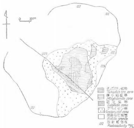
第8図 石英脈の断面図 Horizontal section of quartz vein, Komaki mine
