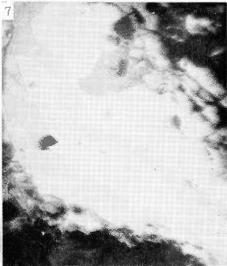
図版7 黄銅鉱（白色）中の黄錫鉱（灰色），中央上部は閃亜鉛鉱（暗灰色） Stannite (gray) in chalcopyrite (white) sphalerite (dark gray) in the upper central part ×800 Reflected light
