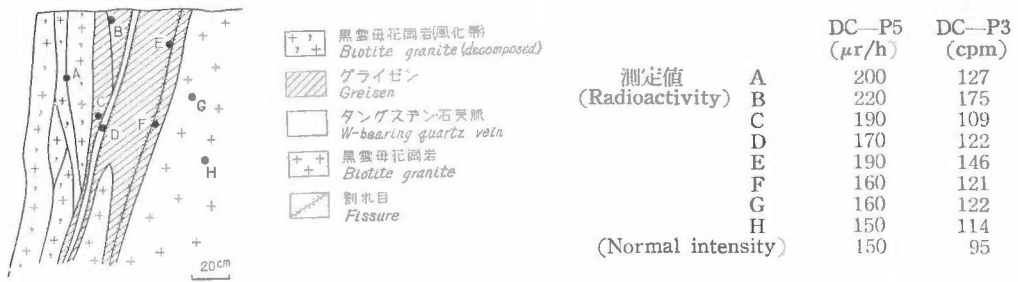
第4図 栄和鉱山南大切坑南押引立 (1957.9.3) Sketch of southmost heading of Minami-ōgiri-kō, Eiwa mine
