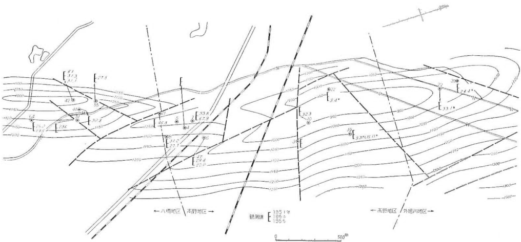
第77図 八橋油田地化学調査図 VII層, \text{NH}_4^+-\text{N} (mg/l)
