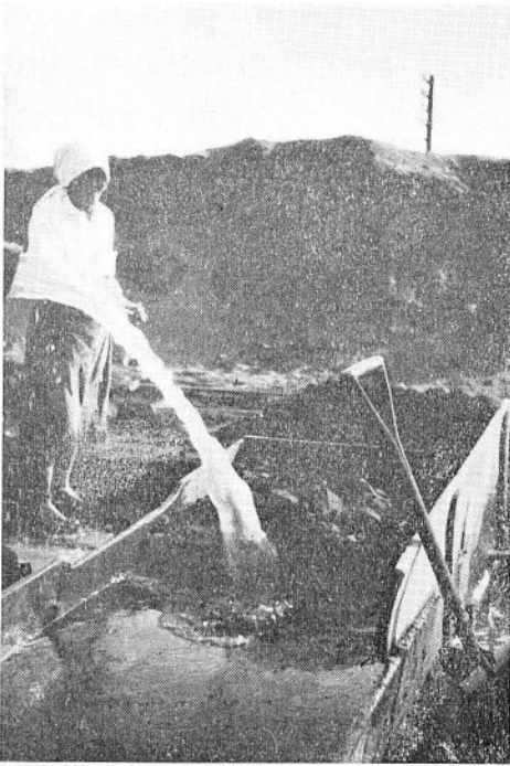
図版 7 樋流し。樋の傾斜は 6~7° 手前の板の上に精鉱がたまる。長万部町中ノ沢、日鉄中ノ沢鉱山小村第 1 現場。
