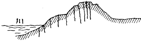
第三圖 (塚崎堤防ノ龜裂)
