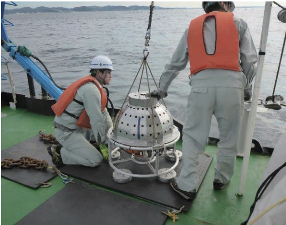
写真2 海底重力調査風景。 Photo 2 Ocean bottom gravity measurements.
