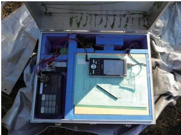
第7図 地磁気日変化観測装置内部。
