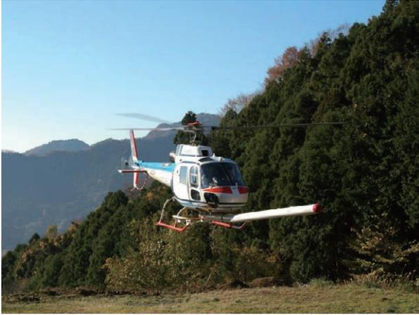
第 2 図 空中磁気探査調査ヘリコプター (中日本航空 (株) 所有). AS350B3 型機. 機体下部にスティンガーを固定し, その内部に Cs 磁力計センサーおよびプリアンプ, フラックゲート型磁力計センサーを収納する.
