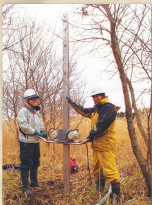
地層抜き取り装置を使った調査風景。長い箱型のを押し込んで、地層をそのまま抜き取ります。
