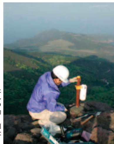
山体変動観測のためのミラーを設置しています。地下でのマグマや熱水の動きを知るためには、現地での変動観測は重要なデータとなります。
