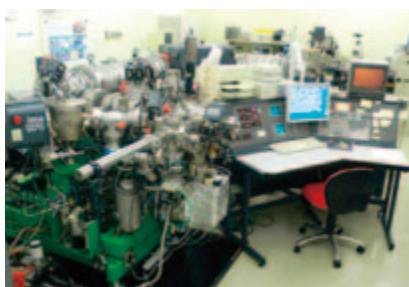
図4 二次イオン質量分析装置(SIMS)。鉱床の生成メカニズムを研究するため、最先端の分析装置で鉱物中の数ミクロンという細かい組織での金の量を測定して、金が沈澱したメカニズムを考察します。
