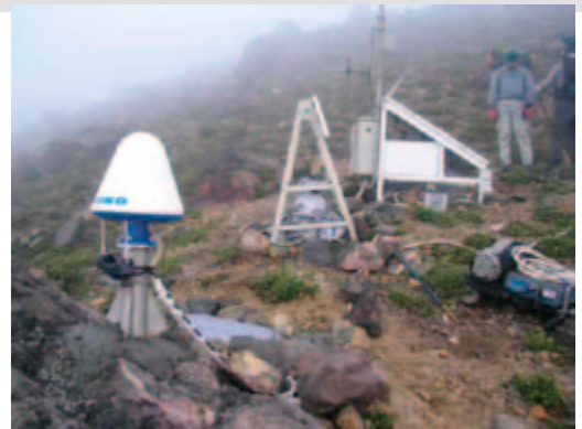
写真4 口永良部島火山におけるGPSによる地殻変動連続観測の様子。
