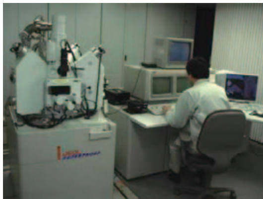
写真1 電子線マイクロアナライザ（EPMA）。電子顕微鏡の一種。数〜数十マイクロンの空間分解能で、組織観察や高精度の化学分析ができます。
