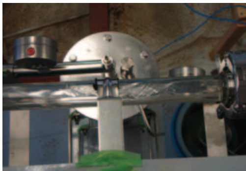
図6 試作透視型CO2圧入装置。pH低下による炭酸カルシウム鉱物抑制効果を確認。
