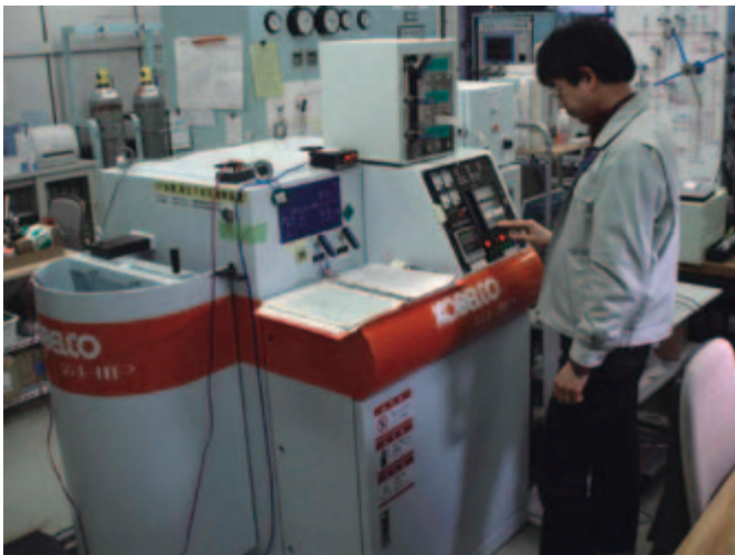
写真3 内熱式ガス圧装置 (HPV)。高温高压状態を発生させ、実験室でマグマを作り出します。地質調査総合センターの装置は、実験試料の落下急冷機構や、減圧速度制御機構も備えています。
