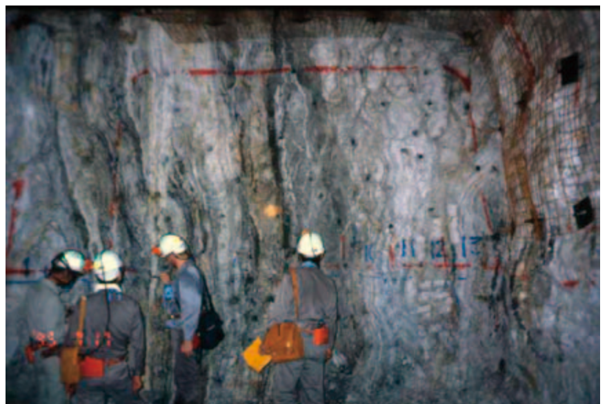
図2 菱刈鉱山(鹿児島県)の鉱脈(引立での観察)。現在操作中の菱刈鉱山は世界でも高品位な金鉱山で、これまで150トン以上の金を産出しましたが、まだそれ以上の金が埋蔵されています。鉱脈は板状ですので、坑内の各レベルで鉱脈の走向方向に掘り進んで開発します。引立(採掘最前線の断面)では脈が良く観察できます。菱刈鉱床のような大規模な含金石英脈は、長い年月をかけて生成します。菱刈では鉱脈全体ができあがるまで、およそ60万年かかったことが分かっています。
