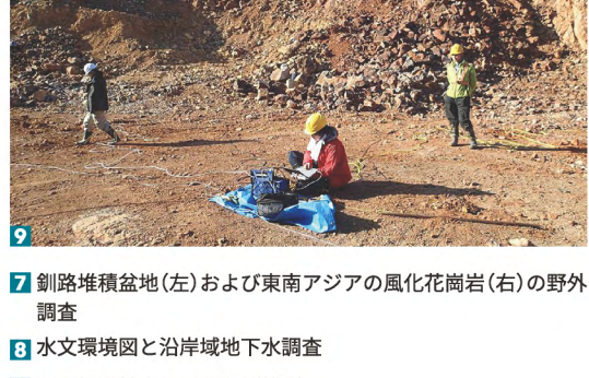
7 釧路堆積盆地(左)および東南アジアの風化花崗岩(右)の野外調査 8 水文環境図と沿岸域地下水調査 9 霧天掘り鉱山でのMT電磁探査
