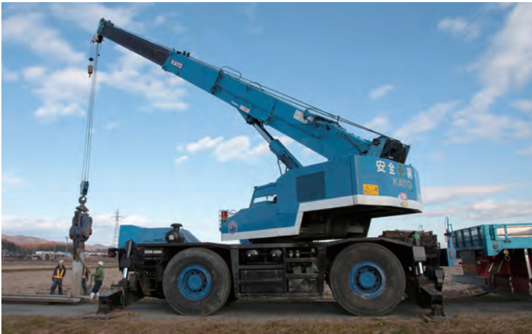
ホイールクレーンを使用したジオスライサー調査。 (2009年12月 宮城県山元町)
