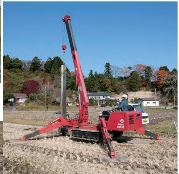
上の写真：小型クローラークレーンを使用したジオスライサー調査。 (2009年11月 福島県南相馬市)
