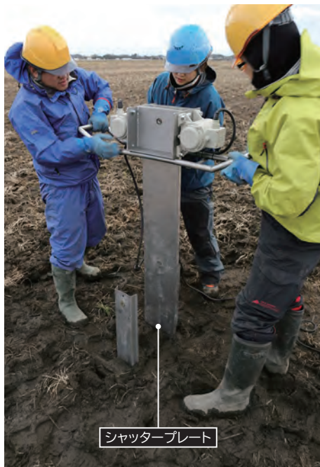
ハンディジオスライサーによる掘削調査。パイブレーターで振動をかけて押し込む様子。 (2017年2月千葉県山武市)
