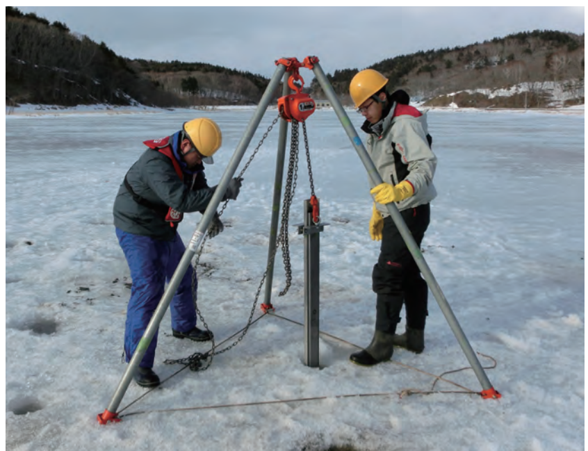
氷上でのジオスライサーによる試料採取の様子。アイスドリルで氷に穴を開け、湖底の泥を採取する。単管パイプで三脚を組み立て、採取のために打ち込んだスライサーをチェーンブロックで引き抜く。
