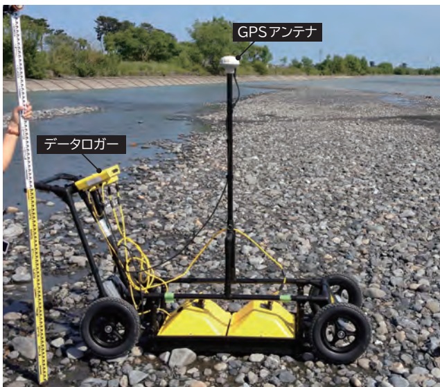
カートタイプの地中レーダーを使用した探査風景。(静岡県静岡市) カートに受送信センサーやデータロガーが一体となったもの。地面が比較的平坦であった場合、作業効率が良いこのタイプが採用されることが多い。(写真撮影・提供 田村 亨)
