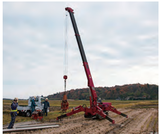
小型クローラークレーンを使用したジオスライサー調査。 (2009年11月 福島県南相馬市)
