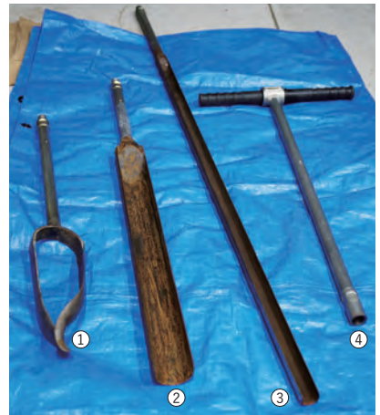
ハンドコアラーで使用する様々な先端部とハンドル部分。左から ①砂を掘るための先端部(このタイプは特に「ハンドオーガー」と呼ぶ) ②口径6cmのコアラー(長さ50cm) ③口径3cmのコアラー(長さ1m) ④ハンドル
