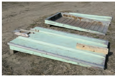
上の写真：ジオスライサー（大型幅広タイプ）を用いた試料採取。（2013年3月 宮城県仙台市）（澤井, 2014 GSI地質ニュースより）
