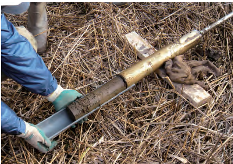
シンウォールサンプラーで採取された試料。現場において試料を押し出し、プラスチックケースに移し替えて運搬する。(2011年2月 徳島県阿南市) (写真撮影・提供 岡村行信)
