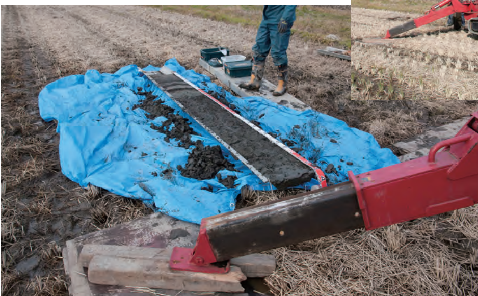
上の写真：小型クローラークレーンを使用したジオスライサー調査。 (2009年11月 福島県南相馬市)
