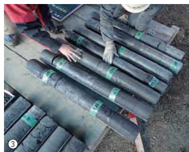
③ 機械ボーリングで採取された試料。現場において試料を押し出し、プラスチックケースに移し替えて運搬する。(2018年12月高知県須崎市)
