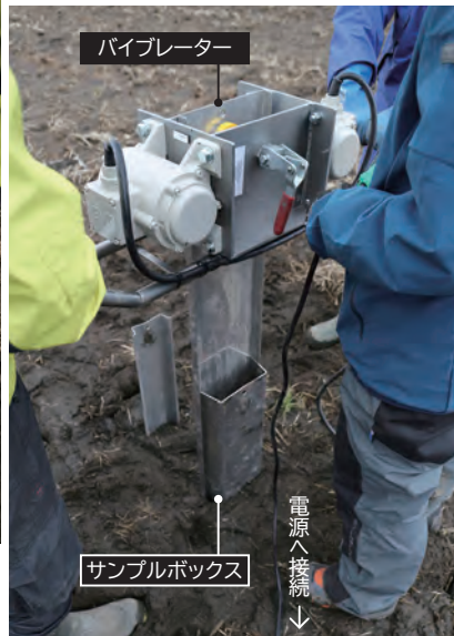
ハンディジオスライサーによる掘削調査。パイブレーターで振動をかけて押し込む様子。 (2017年2月千葉県山武市)
