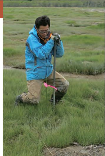
ハンドコアラーを使用した掘削調査。(2015年5月 北海道厚岸町) (写真撮影・提供 谷川晃一郎)
