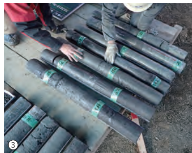
③ 機械ボーリングで採取された試料。現場において試料を押し出し、プラスチックケースに移し替えて運搬する。(2018年12月高知県須崎市)
