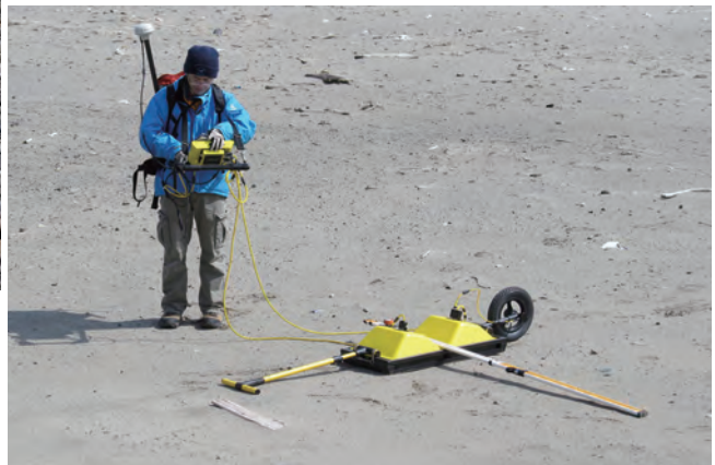
rollerタイプの地中レーダーを使用した探査風景。(宮城県仙台市) 中央にある黄色いセンサー2点が地面を滑り、探査する。(写真撮影・提供 田村 亨)
