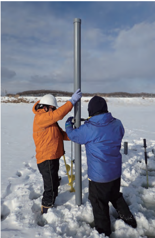
結氷した池での塩ビパイプを使用した掘削調査。氷にアイドリルで穴を開け、そこにパイプを突き刺して湖底の堆積物を採取する。(2021年2月 北海道白糠町)
