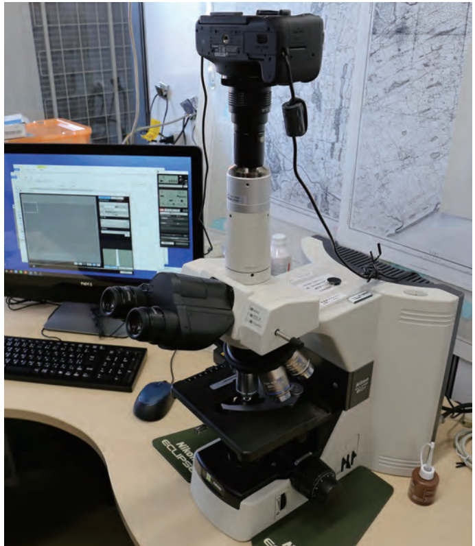
プレパラートに封入されたケイソウ化石を観察するために使用する光学顕微鏡。カメラを装着し、顕微鏡の画像をモニターに表示して観察する。
