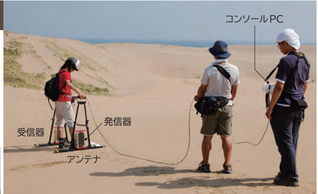
ハンドルタイプの地中レーダーを使用した探査風景。(鳥取県鳥取市 鳥取砂丘) アンテナを等間隔で移動させた後、電磁波を受送信することで、その場所におけるデータを得る。調査対象地域に測線を設け、測線沿いにデータ取得する。(写真撮影・提供 田村 亨)
