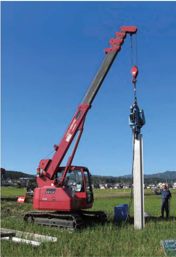
クローラークレーンを使用したジオスライサー調査。 (2012年10月 茨城県北茨城市)
