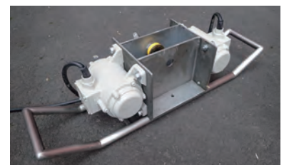
パイブレーター：サンプルボックスやシャッタープレートを挟み、振動をかけることによって地中に押し込みやすくする機材。電気で動くため、小型の発電機と合わせて運用する。
