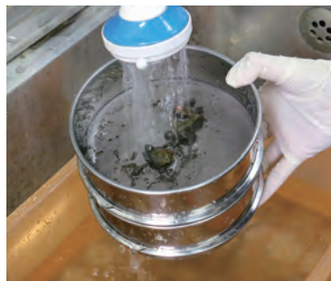
堆積物を篩（ふるい）を使って洗い、泥と植物化石を分離する。
