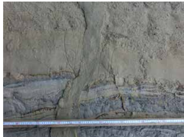
図1 噴砂脈を含む地層の剥ぎ取り標本の例
