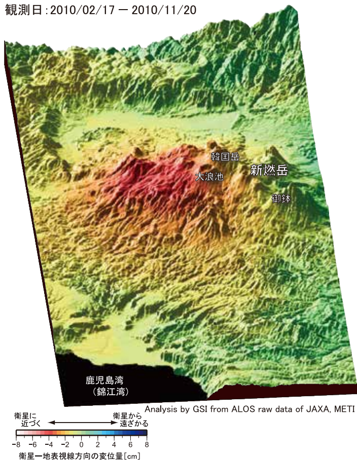
図 1 SAR 干渉解析により検出されたマグマの蓄積に伴う隆起。 赤色の濃い所ほど地面の膨張性変動が大きいことを示します。この変動は、2011 年噴火のマグマの蓄積による隆起と解釈されます。小林ほか (2011) を基に鳥瞰図化。国土地理院小林知勝研究官作成。
