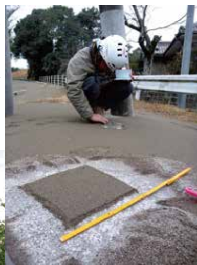
図4 新開発の自動降灰測定器。
