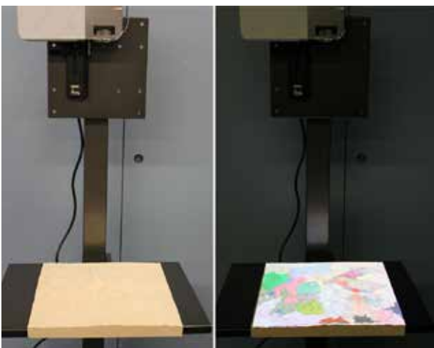
図1 模型へのプロジェクションマッピングの様子。 (左：投影前、右：投影後)。
