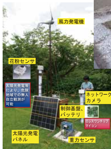
図4 新開発の自動降灰測定器。
