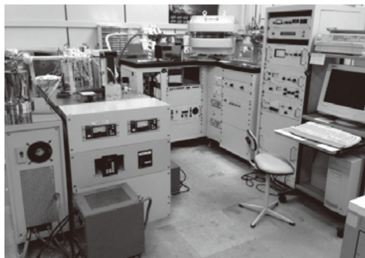
図4 構築中の感度法によるアルゴン測定用希ガス質量分析計 (右: Micromass 5400Ar) および試料前処理ライン (左)。
