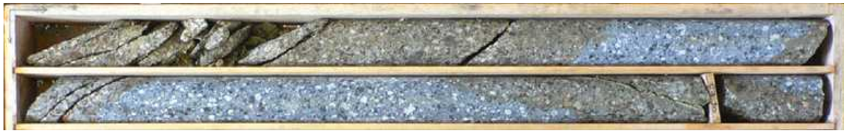
孔1:42.0-44.0m : 割れ目集中部での風化状況 50-60° 傾斜の平行割れ目帯沿いに褐色化。
