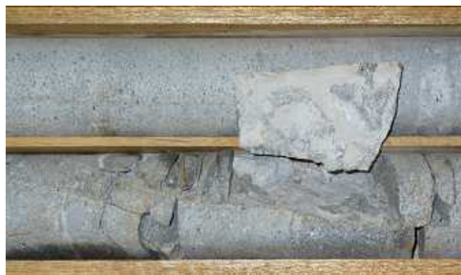
孔1：597.5-597.9m：破碎した岩片・セリサイトを含む割れ目。
