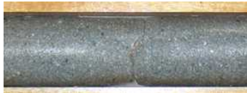
孔1：594.5m：不定形の低角割れ目（自然割れ目）。
