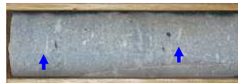
同597.0-597.3m：溶結凝灰岩 （溶結レンズが認められる）
