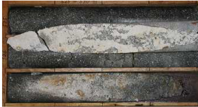
孔1：527.0m:セリサイト脈（割れ目充填物） セリサイトは割れ目全面を充填しておらず、空隙を保持している（水みち）。
