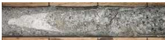
孔1:382.3-382.6m：方解石脈（割れ目充填物）
