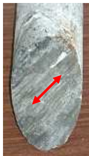
孔1：461.1m：黒色粘土と黄鉄鉱が充填する断層面 (条線の傾斜約50°)
