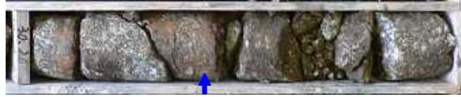
孔1:30.2-30.6m : 風化花崗斑岩の最下部 水みちの低角割れ目に沿ってリモナイトの沈積が著しい。
