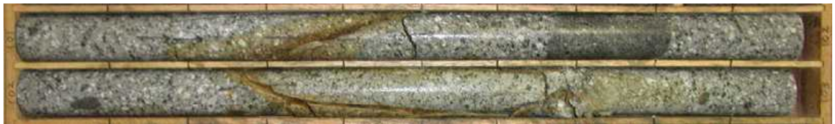
孔1:101.0-103.0m : 風化が認められる最深部での風化状況 70° 前後の高角割れ目沿いに褐色化。
