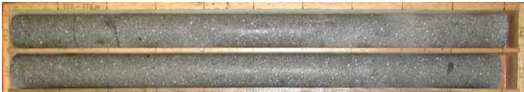
孔1:550-552m：粗粒の軽石凝灰岩相
