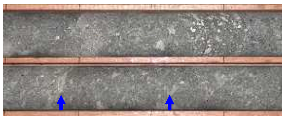
孔1:501.4-502.8m：凝灰角礫岩（溶結レンズが認められる）
