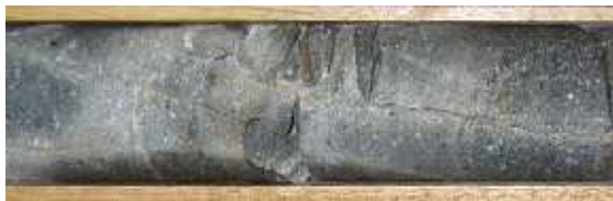
孔1：594.5m：不定形の低角割れ目（自然割れ目）。
