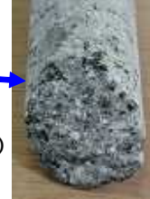
孔1：352.3-352.8m：全量逸泥(92L/min)を生じた割れ目と割れ目面(右) 少量のセリサイト(白色粘土)を充填する節理で、面が滑らか。
