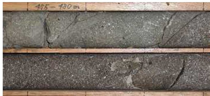
孔1：475.0-476.5m：上半の細粒凝灰岩は割れ目が多く灰緑色に変質。 下半部は割れ目が少なく赤紫色に変質している。接触変成とした方が良いかもしれない。
