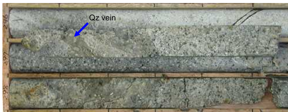
孔1:298.0-298.5m：セリサイトおよび石英脈（晶洞形成：写真の灰色部）が割れ目充填する。
