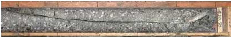
孔1：420.5-421m：固結した断層面を持つ断層(Chlorite) (条線の傾斜約5°、右横ずれか?)
