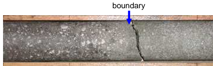
孔1:464.3m付近：花崗斑岩（左）と下位の凝灰岩（右）の境界面。 左の花崗斑岩は赤紫色変質、右の細粒凝灰岩は灰緑色に変質。
