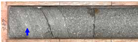
孔1:487.0-487.1m（左）：溶結凝灰岩
