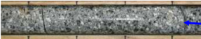
孔1：352.3-352.8m：全量逸泥(92L/min)を生じた割れ目と割れ目面(右) 少量のセリサイト(白色粘土)を充填する節理で、面が滑らか。
