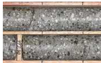
孔1：396.0-398.0m：低角割れ目帯の例。
