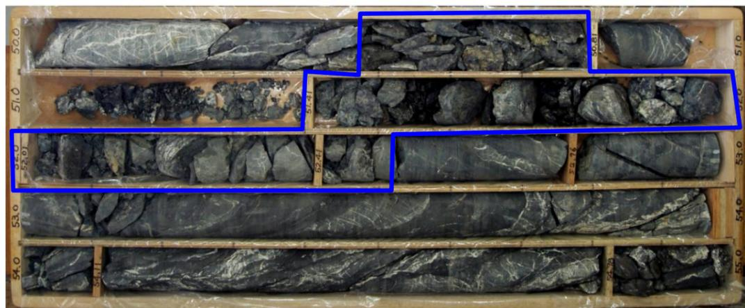
岩級区分 CL 級 (5cm 短柱~角礫状 (円弧を呈する) : 青枠箇所)
