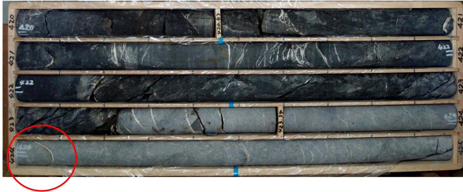
・I1 の深度 424m に分布する方解石脈を採取して X 線回折分析した結果、方解石、石英、菱鉄鉱が確認された。
