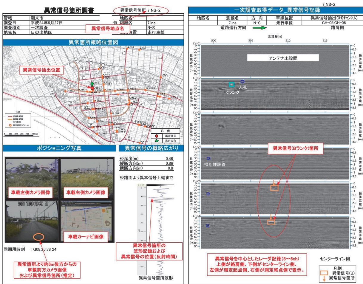
第 6 図 車載型 GPR による取得記録及び異常信号抽出の例
