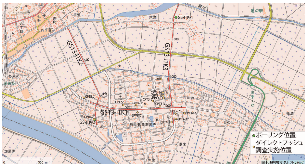
第1図 S波反射法および表面波探査の測線配置. 背景地図は地理院地図を用いた.
