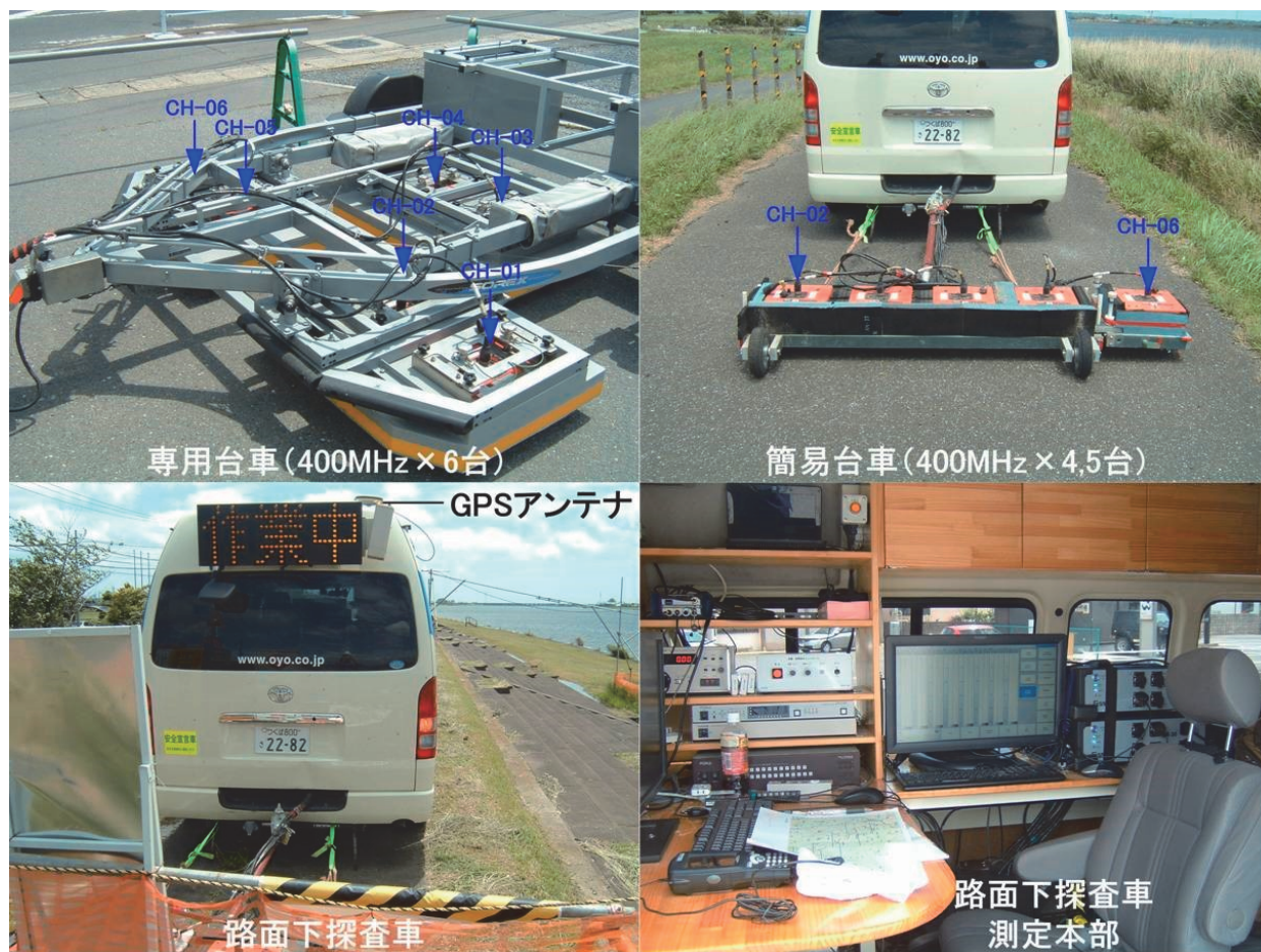
第2図 車載型 GPR データ取得の様子 Fig.2 In-vehicle GPR data acquisition system.
