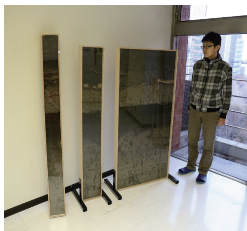
第21図 貸し出し用として短冊状に裁断された津波堆積物の剥ぎ取り標本(澤井 2014b)
