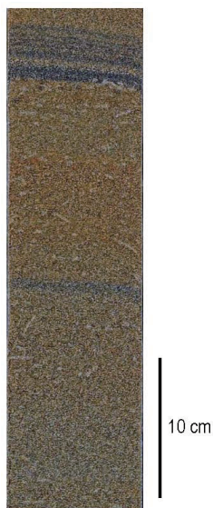
第23図 コア ISMB-3 上部に見られる潮間帯堆積物。白いチューブ状の化石は“マカロニクナス”。 Fig.23 Sand beds formed at the intertidal zone, that yield white tubular burrows of Macaronichnus segregatis -like traces. Upper part of the Core ISMB-3.
