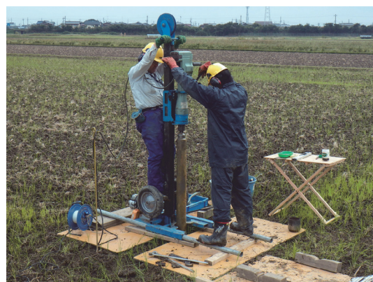
第 4 図 定方位簡易ボーリングによる掘削 (SRT-11) Fig.4 Coring by percussion boring system.
