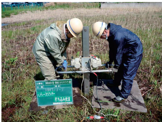
第3図 ハンディジオスライサーによる調査状況 Fig.3 Coring survey by geoslicer system.
