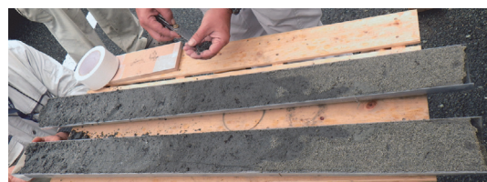
第 6 図 定方位簡易ボーリングコア試料の現地での確認風景 (SRT-25) Fig.6 Core sample of percussion boring (SRT-25).
