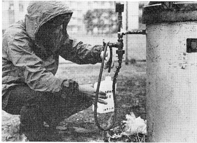
写真V-1 井戸の原水採水用バルブにフリーサイズゴム管を接続して試料容器に採取しているところ
