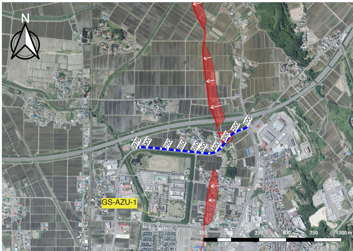
第2図 会津若松市一箕町鶴賀における測線(GS-WIT)のCMP(Common Middle Point; 共通反射点)。基図に国土地理院の提供する地理院タイル「全国最新写真(シームレス)」( https://maps.gsi.go.jp/development/ichiran.html 2019年6月14日確認)。青線(点の集合)はCMPの位置, 数字はCMP番号である。GS-AZU-1は石原ほか(2017)によるボーリングの位置を示す。赤帯は会津盆地東縁断層による撓曲の位置を表し、活断層詳細デジタルマップ(中田・今泉, 2002)によるものである。
