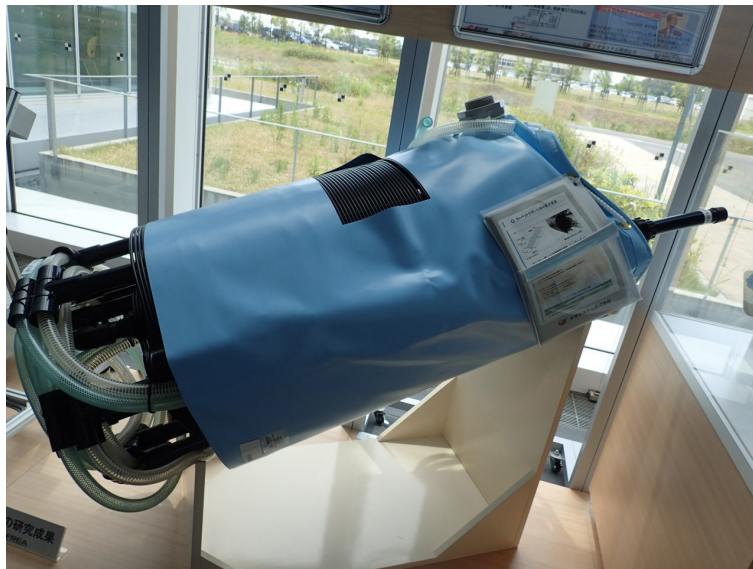
写真1 福島再生可能エネルギー研究所に展示してあるタンク式熱交換器
