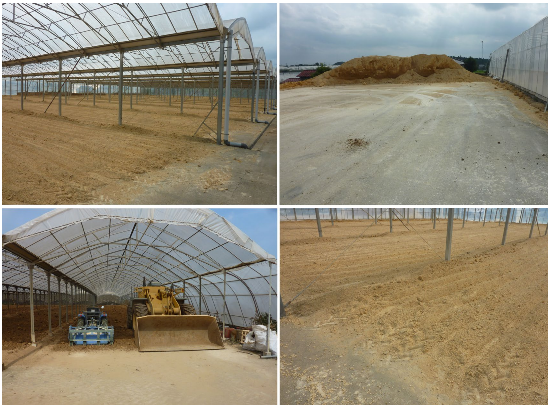
写真4 軽石・ロームの乾燥場。(左上) 乾燥場の大きなビニールハウス。(右上) ビニールハウスの脇には軽石やロームが山積み。(左下) 重機やトラクターが活躍しています。(右下) 畑を耕すように塊はつぶされ乾燥されています。
