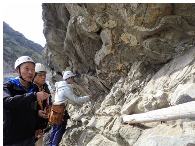
写真4 三津港付近のはんれい岩貫入面の観察と走向傾斜測定.
