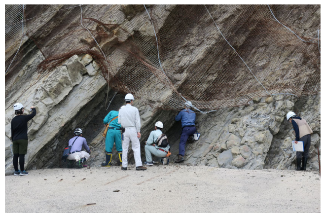
第3図 地層の走向傾斜測定実習(長尾鼻付近)。落石の恐れがあるのでヘルメットを着用しています。
