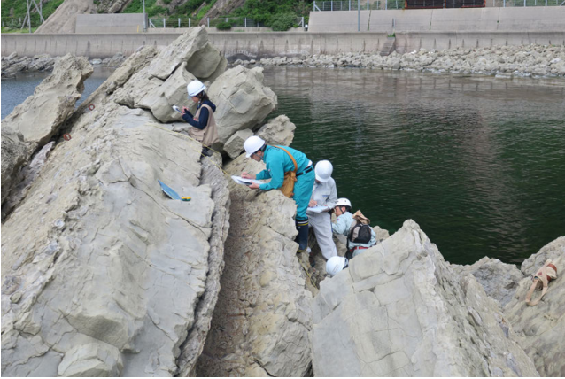
第4図 急傾斜する砂岩泥岩互層の柱状図作成風景(長尾鼻付近). 転倒時の頭部のケガを防ぐためヘルメットを着用しています.
