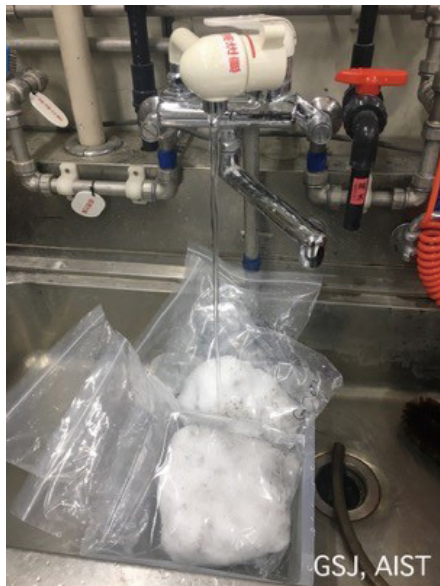
写真5 一定面積の火山灰試料は雪とともに持ち帰ったため, 雪を溶かして乾燥させ秤量する。
