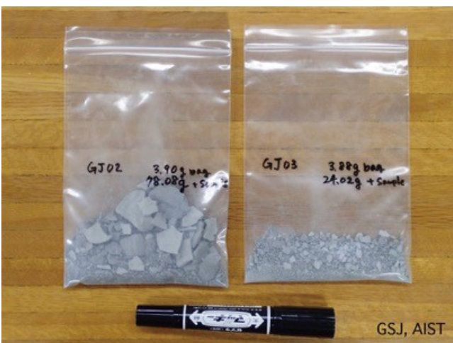
写真6 乾燥させた火山灰試料(30 cm 四方で採取, 大きな塊は乾燥時に表面で固まった粘土)。火口から北東2.8 km 付近の降灰主軸あたりでは823 g/m 2 (GJ02) の値を得た。
