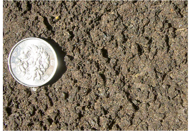
写真1 常陸国分寺講堂跡の礎石(大型8)でのアバタ状の風化面. 100円玉の直径は22mm.
