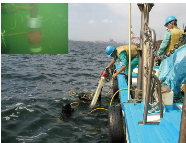
第5図 東京湾における柱状試料の採取。プラスチック製のインナーチューブ(内径6 cm程度、長さ1 m程度)をハンマーで海底に打ち込んで柱状試料を採取。
