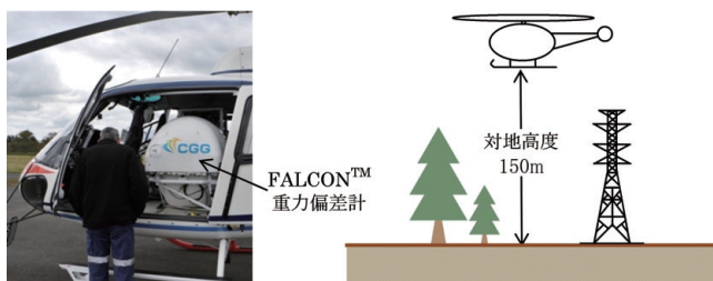
第7図 地熱資源調査に用いた重力偏差計と測定方法。
