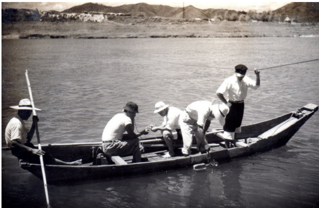
第5図 河川流量測定作業状況。 (河川水がどの程度地下水となるかを知るため川の流量を2か所の断面で測定してその差を求めて算出する)
