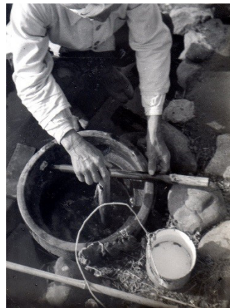
第6図 自噴井調査状況。 (掘り抜き井戸がどの高さまで自噴するかを竹筒を継ぎ足して測定)
