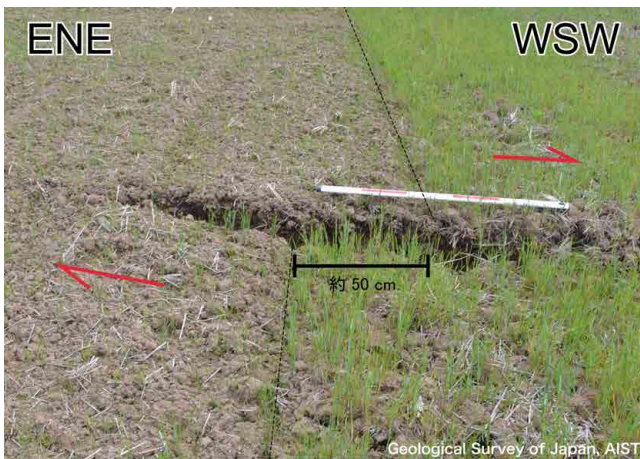
写真10 砥川集落西側の水田に見られる右横ずれ変位。写真は南南東に向かって撮影。耕作跡を基準にした時の右横ずれ変位量は約50 cm。(2016年4月16日撮影)
