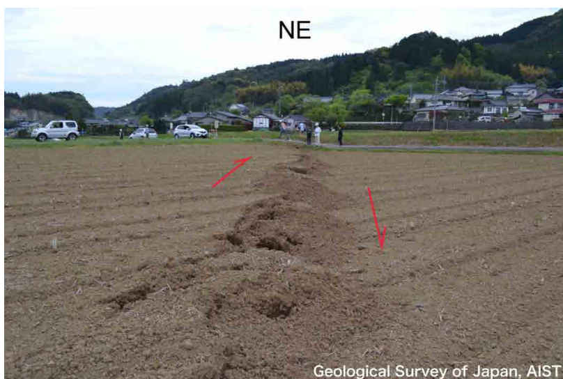
写真4 下陳集落西方に見られる右横ずれ変位とモルトラック。写真は北東方向に向かって撮影。右横ずれ変位量は約100 cm, 上下変位量は約20 cm。(2016年4月16日撮影)
