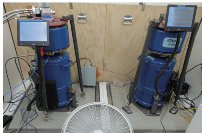
第 2 図 観測室内での SG-SG 並行測定。手前のサーキュレータは空調補助のために追加した。設置位置は第 1 図の AWT3。
