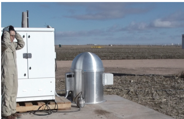
第4図 テキサス州ファンズワースではエンクロージャを活用した屋外観測点での設置。広帯域地震計による並行測定も試みた。設置位置は第1図の1310。
