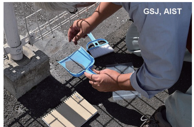
写真2 雨で流され濃集した火山灰の採取(大分市での火山灰採取)。
