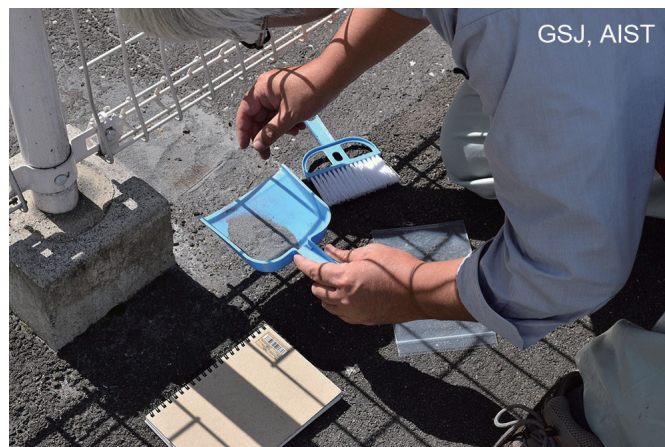
写真4-1 遠方で確認された降灰の痕跡. 10月8日の降雨のため洗い流されているが, 駐車場などに痕跡が残されている. 大分市では最大粒径1-2mm程度の火山灰を採取することができた.
