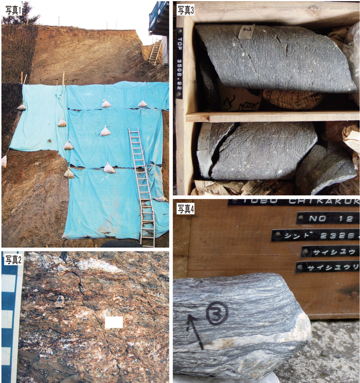
第5図 比企丘陵の切り割りに露出した白亜紀花崗岩(写真1)と接写(写真2)。風化が著しいが、面構造が発達していることが分かる。岩槻地殻観測井の地下3,500 mから採取された白亜紀花崗岩起源のマイロナイト(写真3)と、下総地殻観測井の地下2,300 mから採取された泥質片岩(いずれも防災科学技術研究所が保管)。
