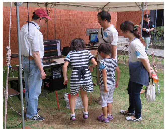
第4図 地震計の前で飛び跳ねたときの震度を測る実験の様子。ビニール袋に包まれた地震計で計測された地震波形と震度がモニタに表示されるようになっています。
