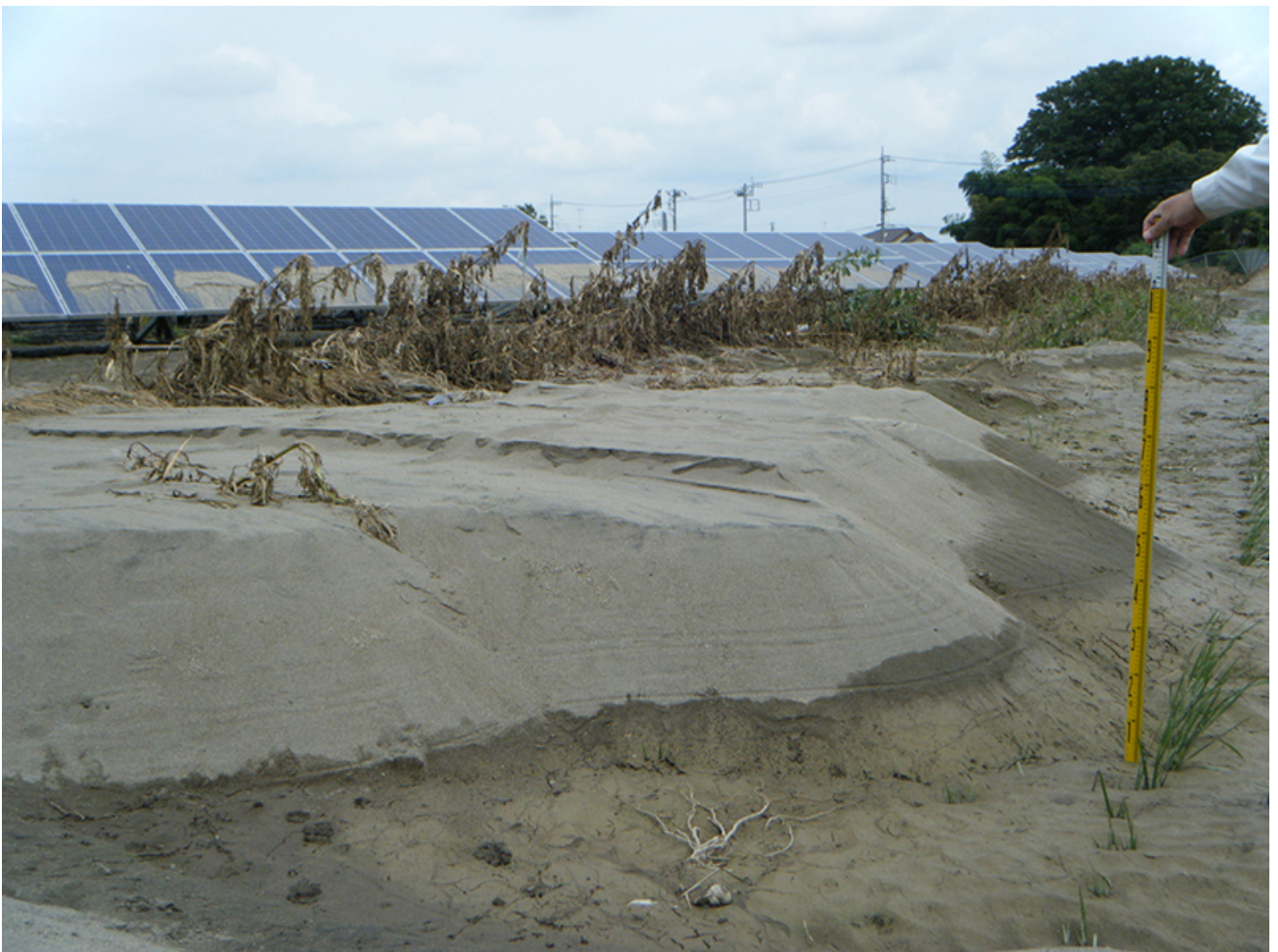
写真 5 越水により水田上に堆積した洪水堆積物。南東方向に伸びる 3D デューンを形成していた。
