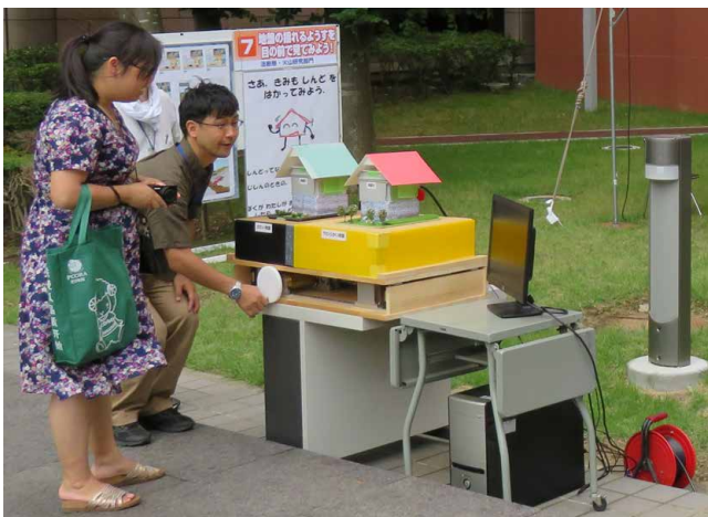
第3図 地盤モデルによる揺れ実験の風景。木の板でできた硬い地盤（黒）とスポンジでできた柔らかい地盤（黄）を手回し振動台で揺らしているところです。各地盤の上には地震計が載っており、その記録がモニタに表示されます。
