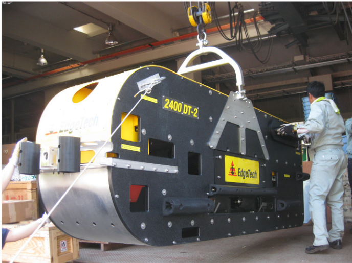
第3図 2014年度に導入した深海曳航式精密海底調査機器。サイドスキャンソナーとサブボトムプロファイラー、インターフェロメトリ式のスワース測深装置、動揺センサー等を装備しており、海底表面の情報、海底表層部の地層情報、海底地形情報を得ることが可能である。搭載したセンサー類を海中（海底面から<100 m）で曳航し、調査船により得られる海底の情報に比べて格段に詳細な精度の情報を得ることができる。また本機器は十分なペイロードおよび通信コネクタを有しているため、今後セシウム磁力計などの各種センサーを追加し、より統合的な地質および海水情報を収集することが期待される。
