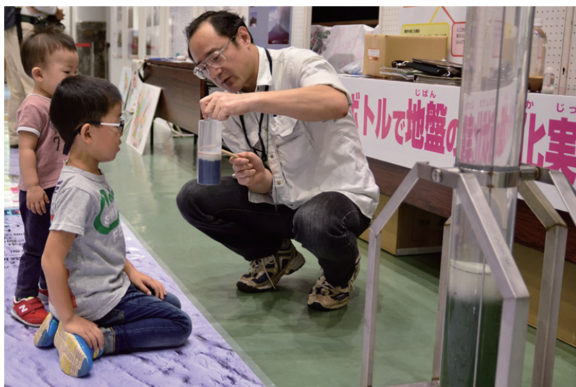
第1図 エキジョッカーを使った地盤の液状化実験とその説明の様子。向かって右側(手前側)にあるのは大型エキジョッカー。
