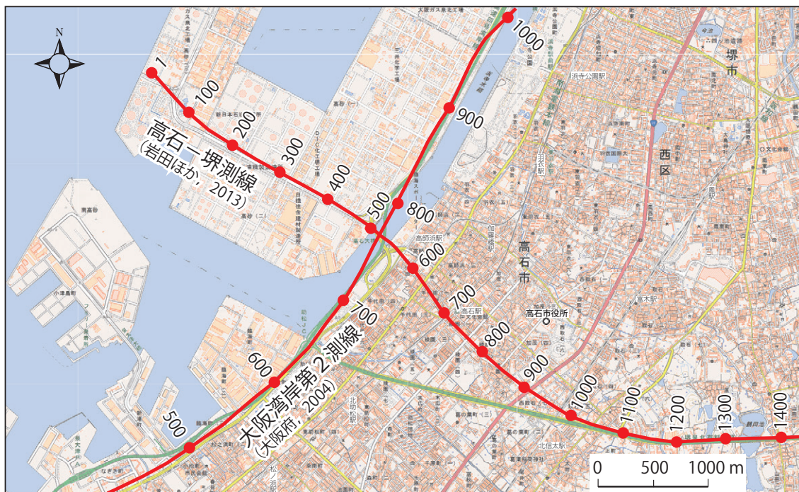
第3図 反射法地震探査が実施された高石-堺測線 (一部; 岩田ほか, 2013) と大阪湾岸第2測線 (一部; 大阪府, 2004)。測線沿いの数字は共通反射点番号 (CMP No.)。基図には地理院地図 ( http://maps.gsi.go.jp ) を使用, 2015/10/01 参照。
