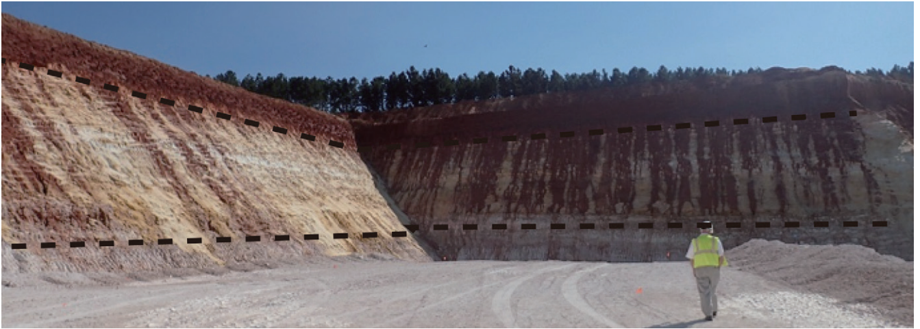
第1図 ジョージア州アンダーソンビルにある Larkin 鉱山 (IMERYS 社). 上部から, 褐色のカオリン層 (中新世), 黄色のカオリン層 (始新世), 白色のカオリン層 (暁新世) となっている.
