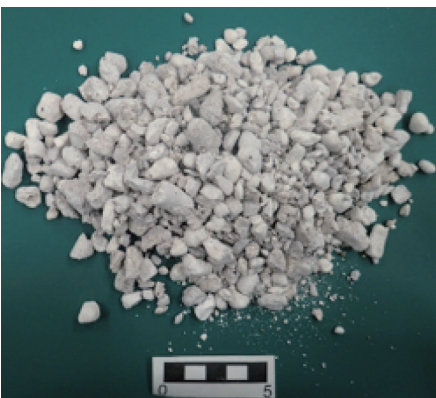
第3図 IMERYS 社プラントで生産している \text{Al}_2\text{O}_3 含有量 47 wt% の Mulcoa 製品.
