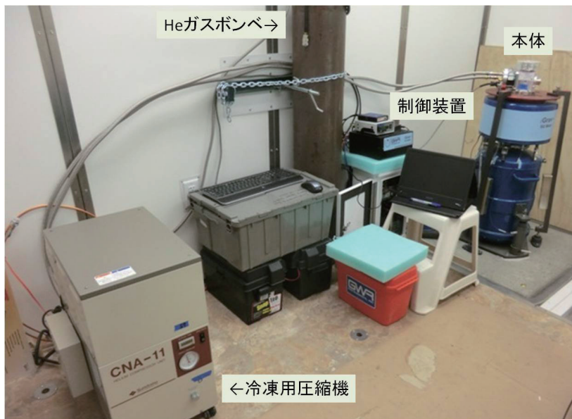
写真5 超伝導重力計 iGrav 一式。制御は本体上部円筒内に組み込まれた基板と小型制御ボックスとノート PC で行われる。リモート制御も可能。本体冷凍機は冷凍用圧縮機に接続している。ヘリウム気化温度以下（絶対温度 4 K）の冷凍機能により正常動作中のヘリウム供給は不要。ヘリウムガスポンペはメンテナンス用である。
