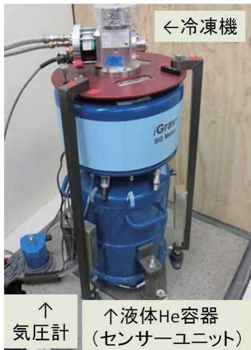
写真4 超伝導重力計 iGrav 本体部分と併置された気圧計。センサーユニットは本体下部の液体ヘリウム容器内に設置されている。冷凍機は絶対温度 4 K を実現する。
