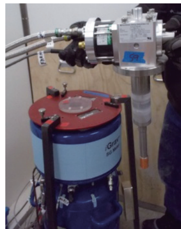
写真6 超伝導重力計 iGrav 本体上部から冷凍機（コールドヘッド）を引き出した状態。
