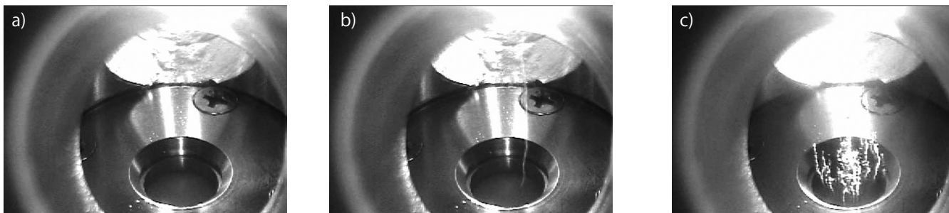
第1図 試料表面からのCO 2 のブレイクスルーの様子：a) ブレイクスルー前，b) 試料表面上1点からのCO 2 のブレイクスルー，c) 試料全面からブレイクスルー。
