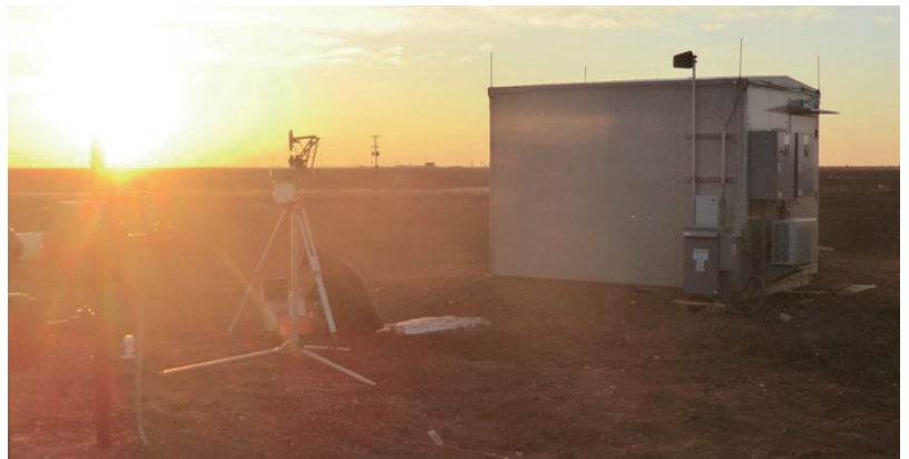
写真1 ファーンズワースではCO 2 注入による石油生産増産効果も狙う実証試験が行われる。石油井が点在する調査サイトに重力計測小屋 iHut を設置した。地形は極めて平坦で、起伏のない地平線から朝日が昇る。
