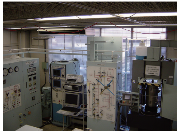
写真2 産総研が所有するガス圧式高温高圧変形試験機。断層深部における温度圧力条件を再現できるよう設計されている。
