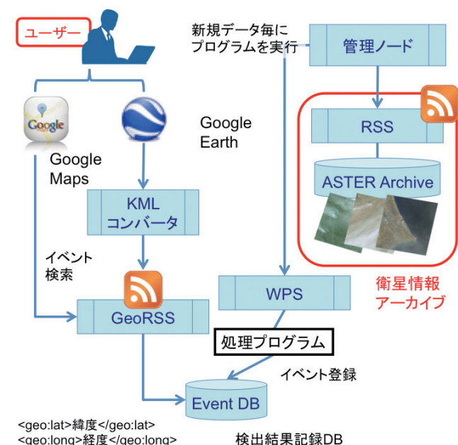
第3図 ASTER高温領域検出システムの処理の流れ。衛星情報アーカイブに新規観測データが追加される都度自動的に処理を実行する。検出記録は位置情報付きRSS形式で配信され新規イベントを容易に表示できる。
