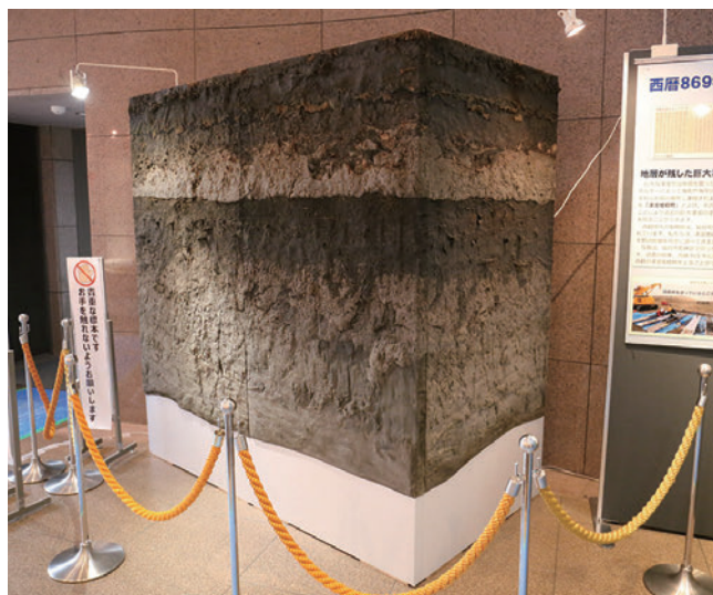
写真2 地質標本館に展示されている津波堆積物のはぎ取り標本（2013年12月撮影）。一番下の砂層には、海側（左）から陸側（右）に向けて傾斜した葉理が見られる。
