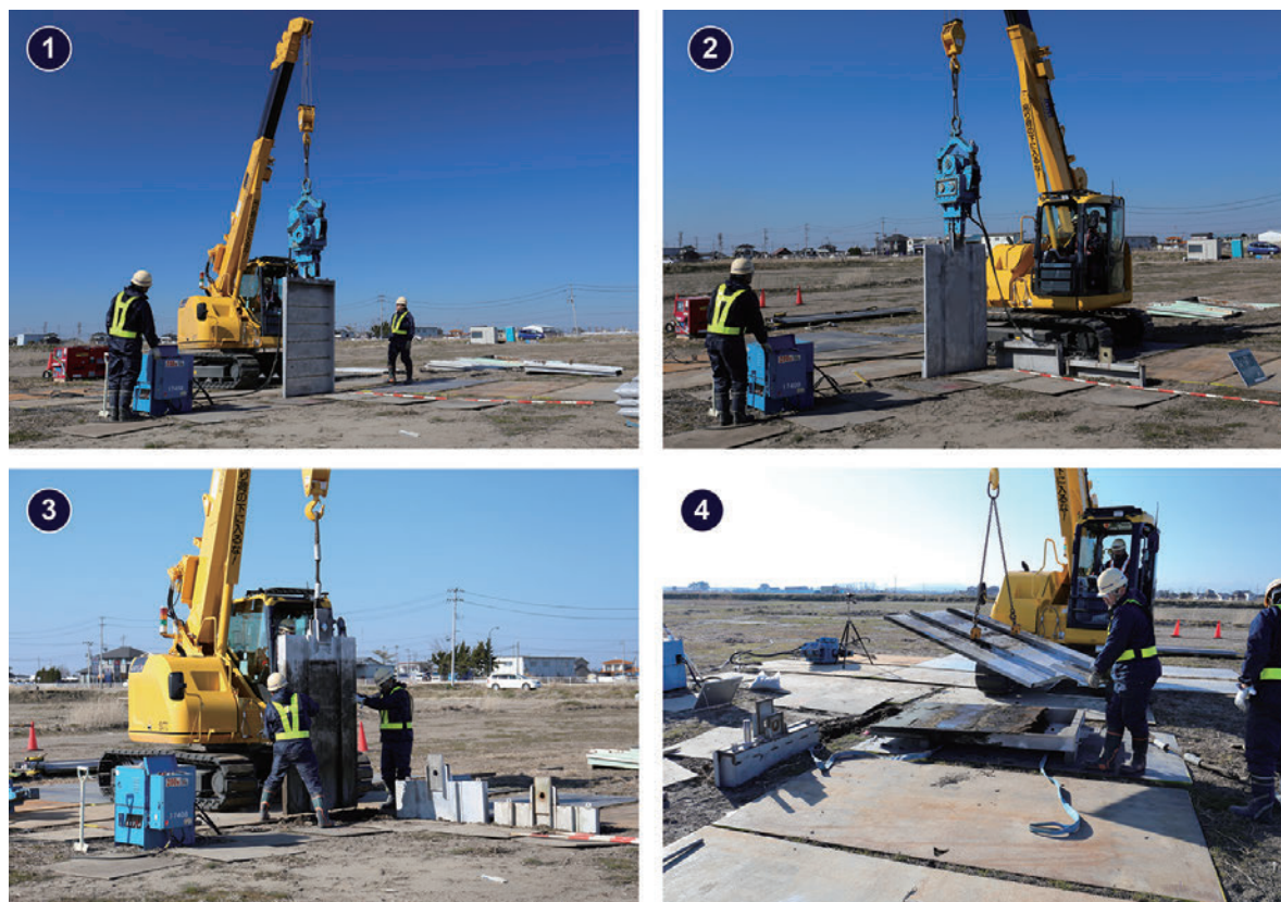
第2図 地層抜き取り装置による試料の採取風景（宮城県仙台市にて2013年3月撮影）。
