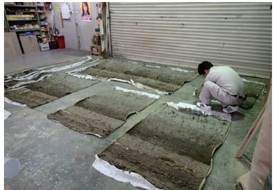
第3図 地層からはぎ取った標本を並べている様子。大きくはぎ取った標本は短冊状に切断し、展示用および貸し出し用の標本に加工した。写真の手前が地層の上位。
