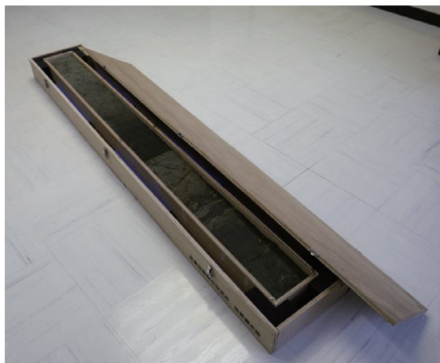
写真3 貸し出し用のはぎ取り標本。標本を運搬するために専用の木箱も作製した。木箱の中には緩衝材が入っており、運搬時に破損がないよう工夫されている。手前側が地表面に相当。
