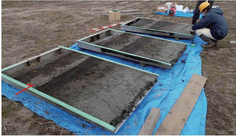
第1図 地層抜き取り装置によって採取された堆積物試料。赤色の矢印で示された層準が西暦869年貞観地震による津波堆積物。これらの試料の表面をはぎ取り、展示用標本を作製する。地層抜き取り装置による試料の採取方法については、本号の記事を参照。
