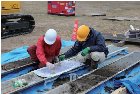
第2図 はぎ取り標本を作製するために接着剤を塗布している様子。
