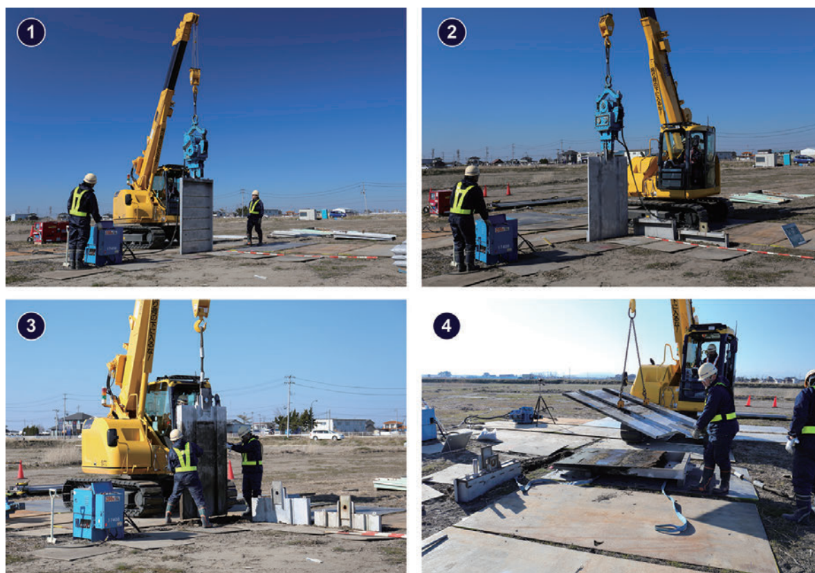
第2図 地層抜き取り装置による試料の採取風景（宮城県仙台市にて2013年3月撮影）。
